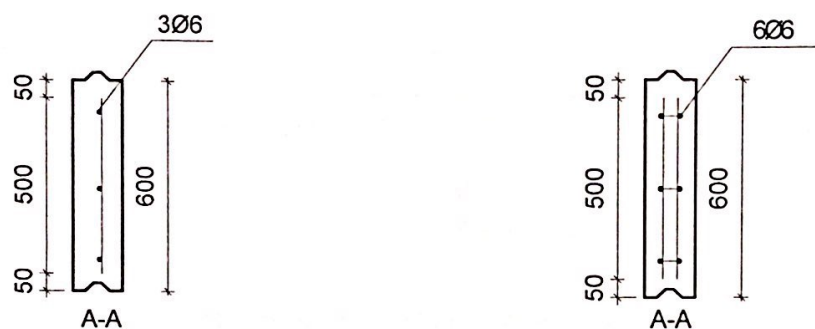
a. Mặt cắt tấm không có rãnh âm dương b. Mặt cắt tấm có rãnh âm dương
